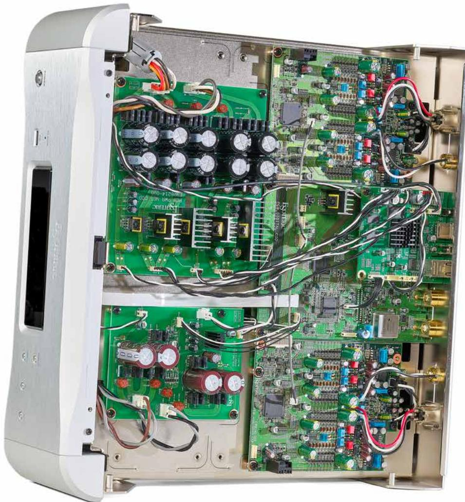
Innenansichten, Teil 1: Im Top-Teil des Top-Geräts findet die Signalverarbeitung statt. Wenn Sie genau hinsehen, entdecken Sie an den räumlich getrennten Signalausgängen die beiden kanalgetrennten FPGA-Wandler. Dazwischen liegen Streamer, Eingangswandler und der silberne gekapselte Taktgeber. Links davon liegen die beiden Platinen für die Aufbereitung der filigranen digitalen und analogen Kleinströme. Und nun bitte umblättern ...
